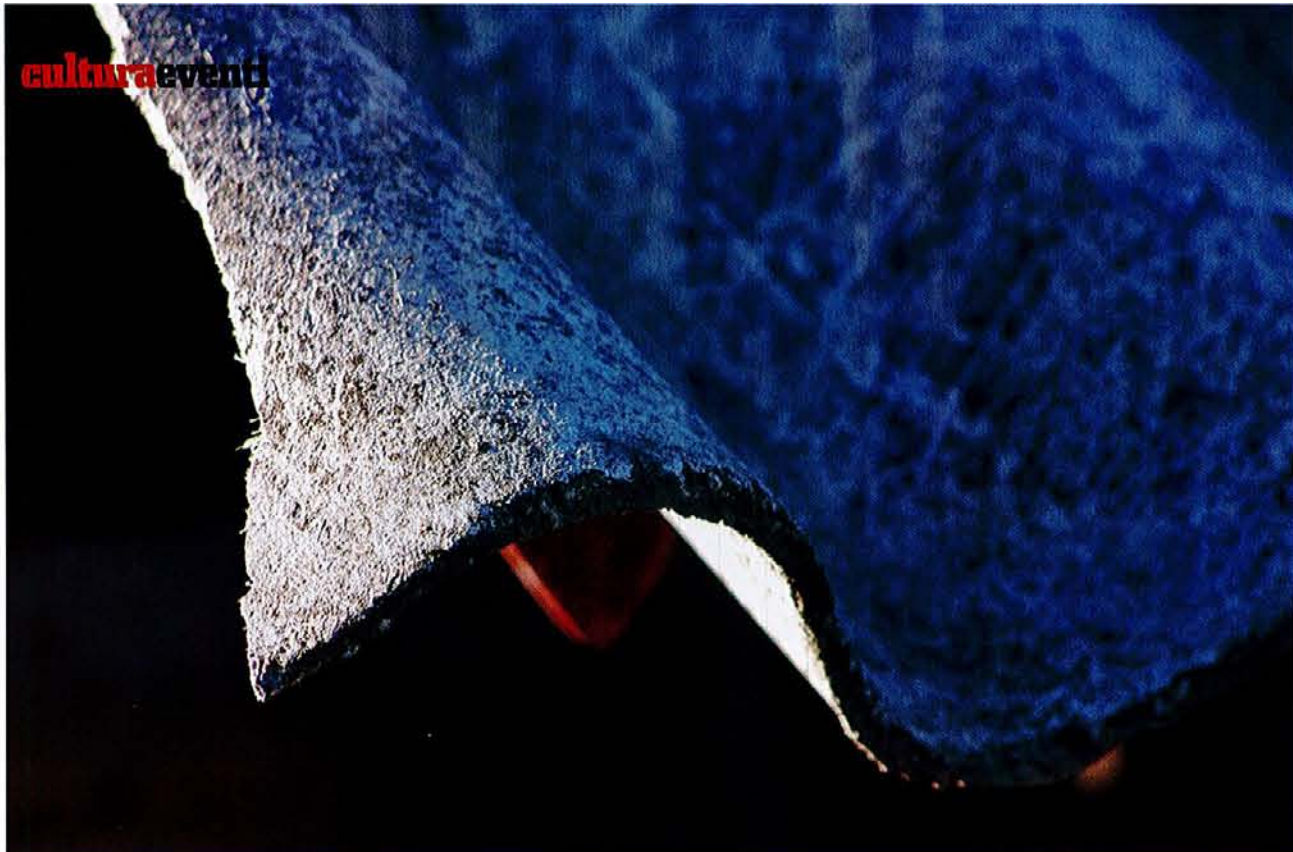
Una tegola di amianto
